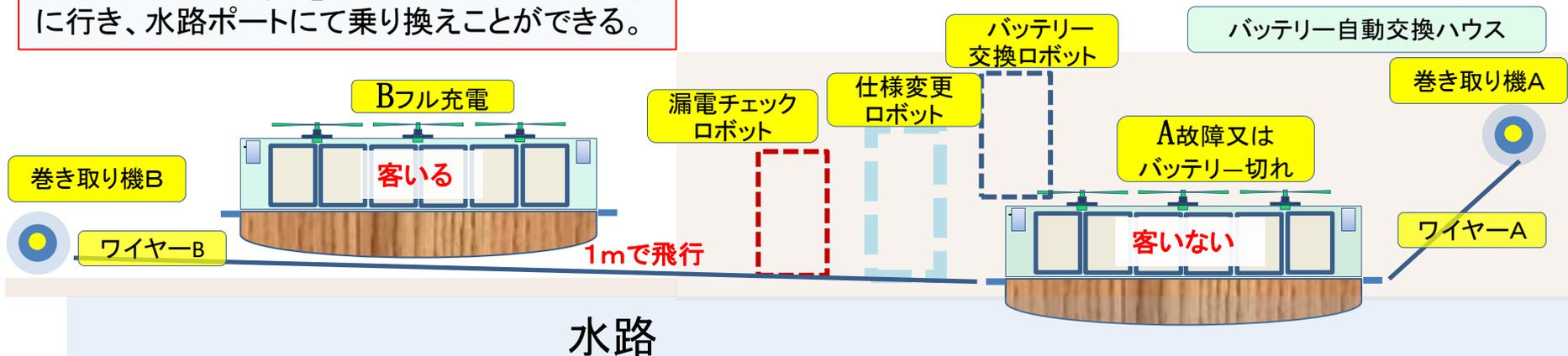
水路内では、巻き取り機のワイヤーにてけん引する。A&Bの巻き取り機の連動により、精密な位置決めが可能になり、各種ロボットによる作業が正しく行われていく。
